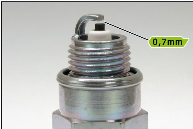
Verifique a menudo el estado de la bujía para saber si el motor realiza correctamente la combustión.
