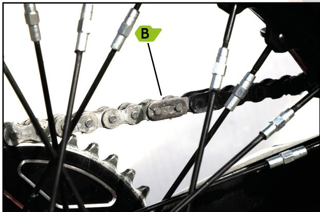
Le réglage de la tension doit se faire en desserrant l'écrou de l'axe et en faisant tourner l'axe de la roue avec une clé Allen de 8 jusqu'à obtenir la tension souhaitée.
