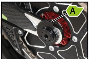
El ajuste del tensado deberá realizarlo aflojando la tuerca del eje y haciendo girar el eje de rueda con una llave Allen de 8 hasta conseguir el tensado necesario.
