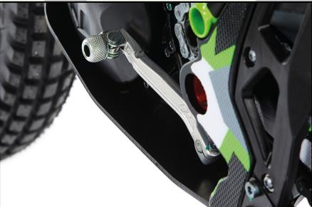
Puntera de la palanca del cambio
